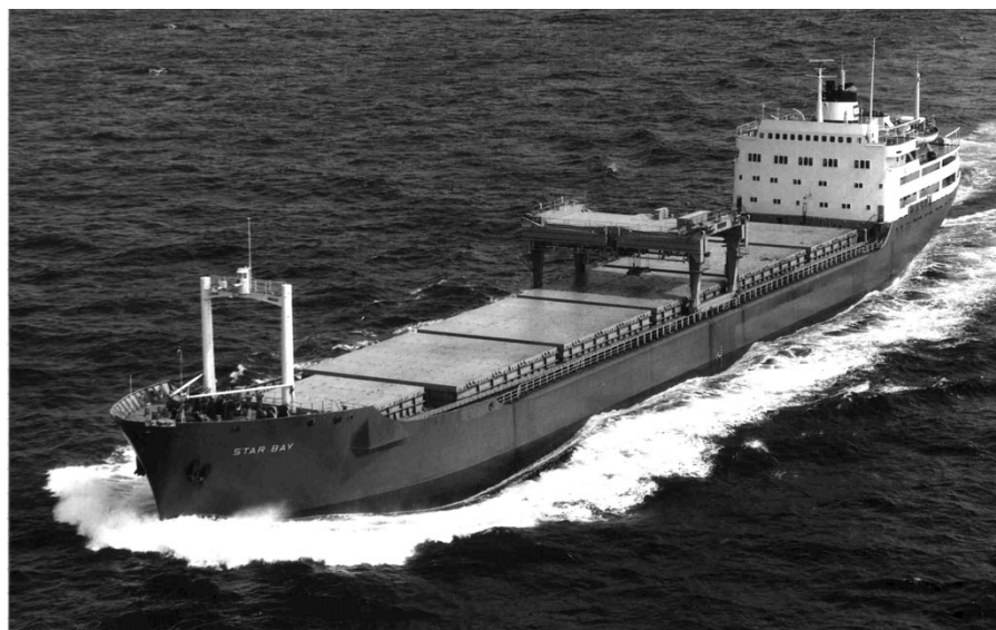
De første store openhatch-skip var tre vanlige bulkskip fra Bergens Mek Verksteder som i 1966/67 ble bygd om for KS Billabong og Westfal-Larsen & Co, som MB2028 (21850 tdt) fra BMV i 1961. Skyfotos
