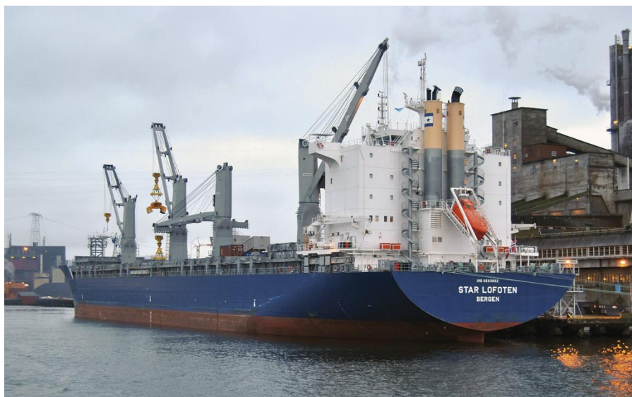
Fra 90-tallet er det bygd openhatch-skip med job-kraner (dreibare), som MB2028 (50728 tdw) levert i 2013 fra Hyundai til Grieg Star Shipping. Bildet er tatt på Herøya i april 2014, tatt av Tomas Østberg-Jacobsen
