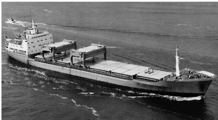
De to første openhatch-skip var søstrene Mb2028 og Mb2028 (9200 tdt), bygd 1962/63 på Kaldnes Mek Verksted for rederiet Chr Østberg, Oslo. Store luker og gantry-kraner. Ukjent fotograf
