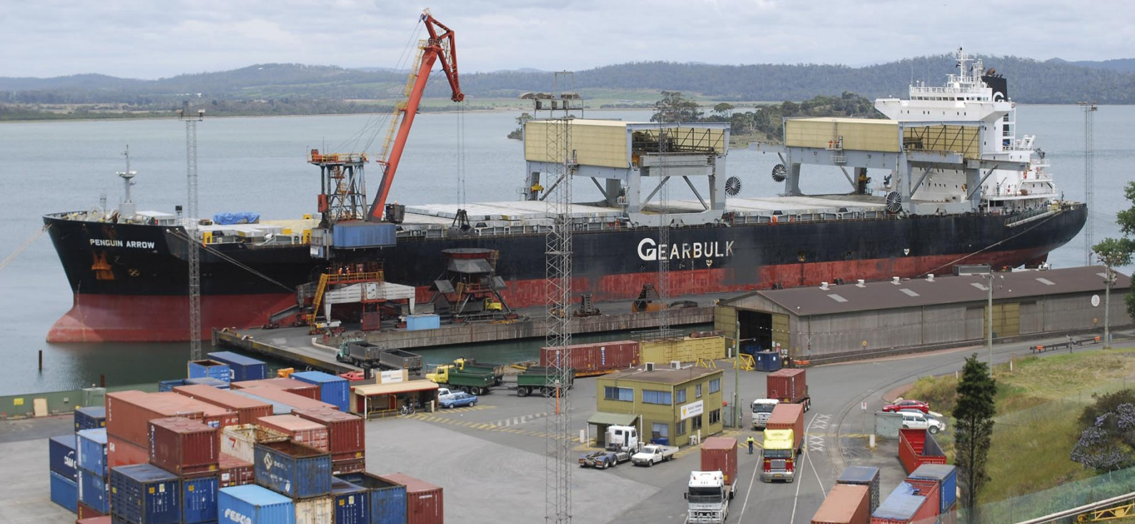
Tradisjonelle openhatch-skip skilte seg fra andre skipstyper med veldig store luker og kjørbare gantry-kraner, som MB2028 (51800 tdw), bygd 1997 på Dalian i China for Gearbulk, eiet av Kristian Gerhard Jebsen. Det har også værbeskyttelse over kranene for å kunne laste/losse i regnvær. Foto Mith Smith
